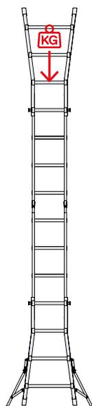
Les échelles articulées devaient déjà correspondre aux tests imposés de la partie 2 de la norme EN 131. Pour les échelles dotées de plusieurs paires d'articulations, la charge testée doit être **placée au-dessus de la paire d'articulations la plus haute.**
