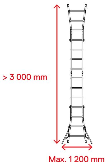
Les échelles articulées, comme les échelles télescopiques ou les échelles polyvalentes doivent se conformer aux directives de construction de la partie 1 de la norme EN 131. Ces dernières prévoient que toutes les échelles pouvant être utilisées en tant qu'échelles simples et mesurant **plus de 3 000 mm de longueur** une fois dépliées doivent être équipées d'un stabilisateur. La longueur du stabilisateur dépend de la longueur de l'échelle, mais s'élève toutefois à **1 200 mm maximum.**
